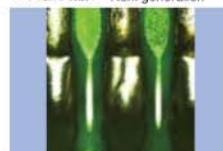
冷熱後のフラックス残さ連結亀裂発生無し No connected cracks observed after TCT
