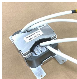
HDF SW トランス外観
