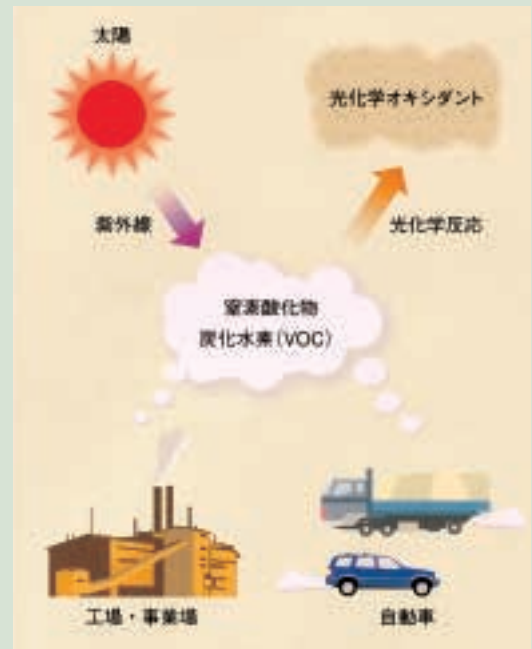
VOCによる光化学大気汚染発生のメカニズム(イメージ図)
