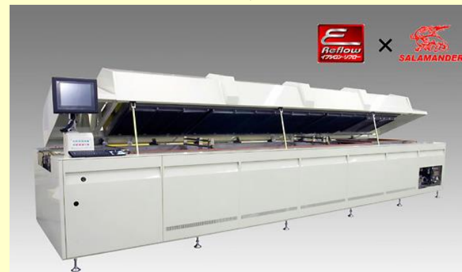
高速生産対応N2リフロー装置 「TNC51-6212EM」
