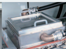
ヒューム回収ユニット Flux fume recovery unit
