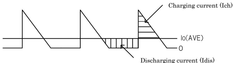
$$I_{\text{ripple}} = \sqrt{I_{\text{dis}}^2 + I_{\text{ch}}^2}$$
